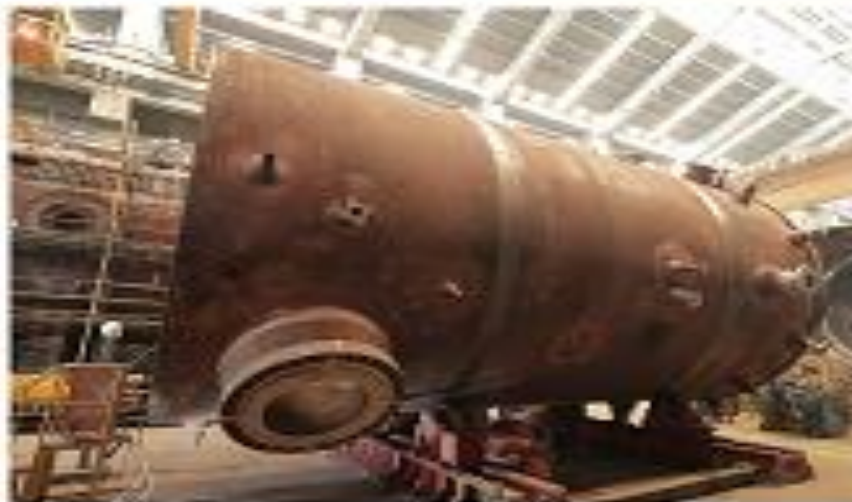
SH 4+5+6 - 2 nd Gasifier
